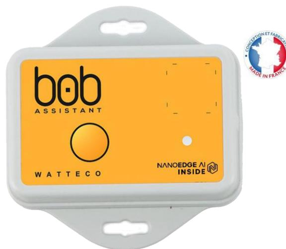
**BoB Assistant** surveille la signature vibratoire d'un équipement (pompe, ventilation, etc...) sur les plages 0 à 400Hz (± 6Hz) et 0 à 12,4kHz (± 200Hz) toutes les 5 minutes (réglable).
